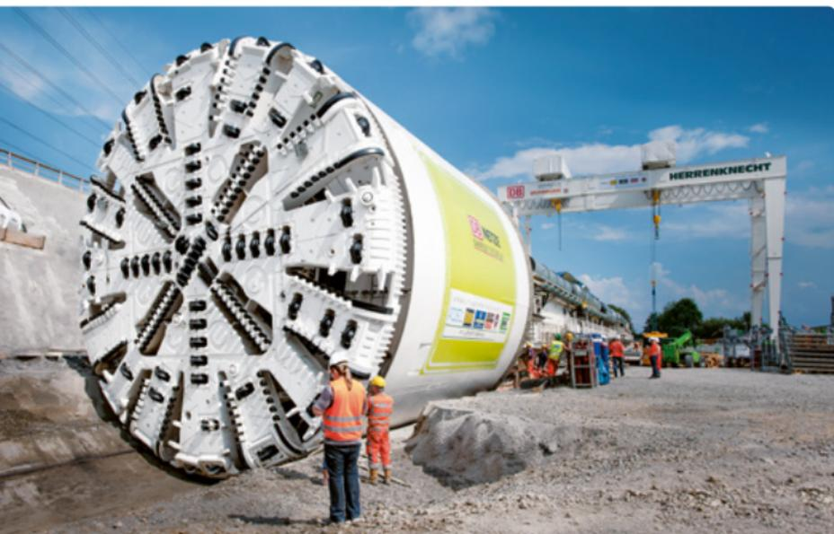
Beispiel einer Tunnelbohrmaschine
