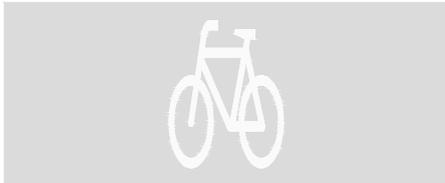
Die Markierung des Sinnbilds "Radverkehr" kann ggf. die Verdeutlichung oder Führung des Radverkehrs unterstützen. Die Anwendung ist vor Ort zu prüfen (Länge: 1,30 m, Breite: 1,00 m, bei breiteren Radverkehrsanlagen: Länge: 2,60 m, Breite: 2,00 m empfohlen)
