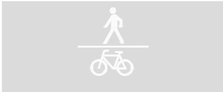
Markierung bei gemeinsamer Führung mit dem Fußverkehr, nach Einmündungen/Knotenpunkten, ohne Benutzungspflicht für den Radverkehr (Länge: 1,00 m, Breite: 1,00 m)
