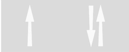
Verdeutlichung des Einrichtungs- oder Zweirichtungsverkehrs durch Pfeilmarkierung ggf. in Kombination mit der Markierung des Sinnbilds "Radverkehr" (Länge: 1,25 m)
