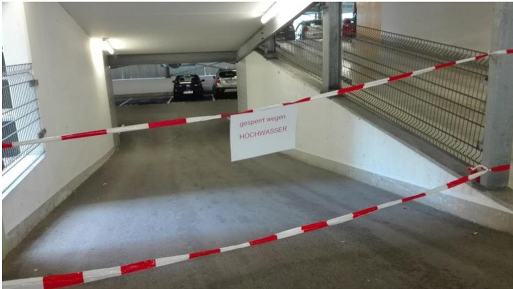
**Abbildung:** Beispiel einer organisatorischen Maßnahme - Gemäß Alarm- und Einsatzplan wird die Zufahrt ins Tiefgeschoss des Parkhauses bereits bei drohenden Starkregenereignissen als Vorsorge-
